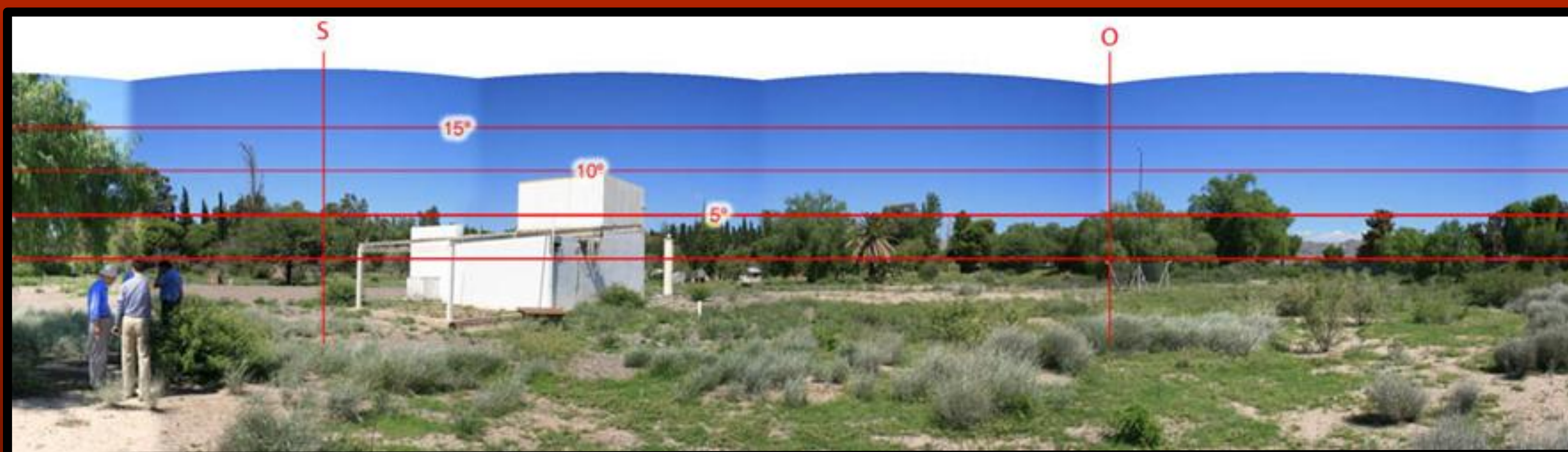
Sitio 1 en el predio de la Sede Central del OFA. Vista panorámica alrededor de la cúpula del telescopio SLR y antena GPS. Las líneas horizontales indican la visibilidad del cielo a 5°, 10° y 15° sobre el horizonte. Se observa que la vegetación es importante y obstruye la visibilidad por debajo de los 5°.
