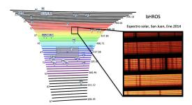
Espectro del Sol tomado con las fibras directamente apuntando a la luz solar que permiten apreciar el correcto funcionamiento del montaje óptico y como funciona correctamente el divisor de imágenes (*image slicer*) que divide la imagen de la fibra en 6 tajadas. Se ha utilizado un CCD mucho más pequeño (cámara QSI) que el CCD original del bHROS, y se indica en el espectro echelle de la izquierda el pequeño sector cubierto alrededor de 6300 Å.
